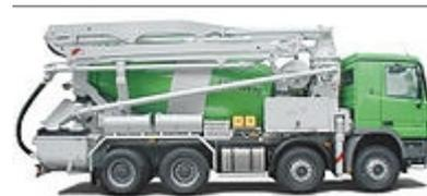
Qualora per lo scarico si debba operare in posti poco accessibili si utilizzano dei camion betoniera dotati di un braccio estensibile con annesso un tubo: una pompa consente al cemento di scorrervi all'interno per effettuare la gettata nel luogo voluto.
