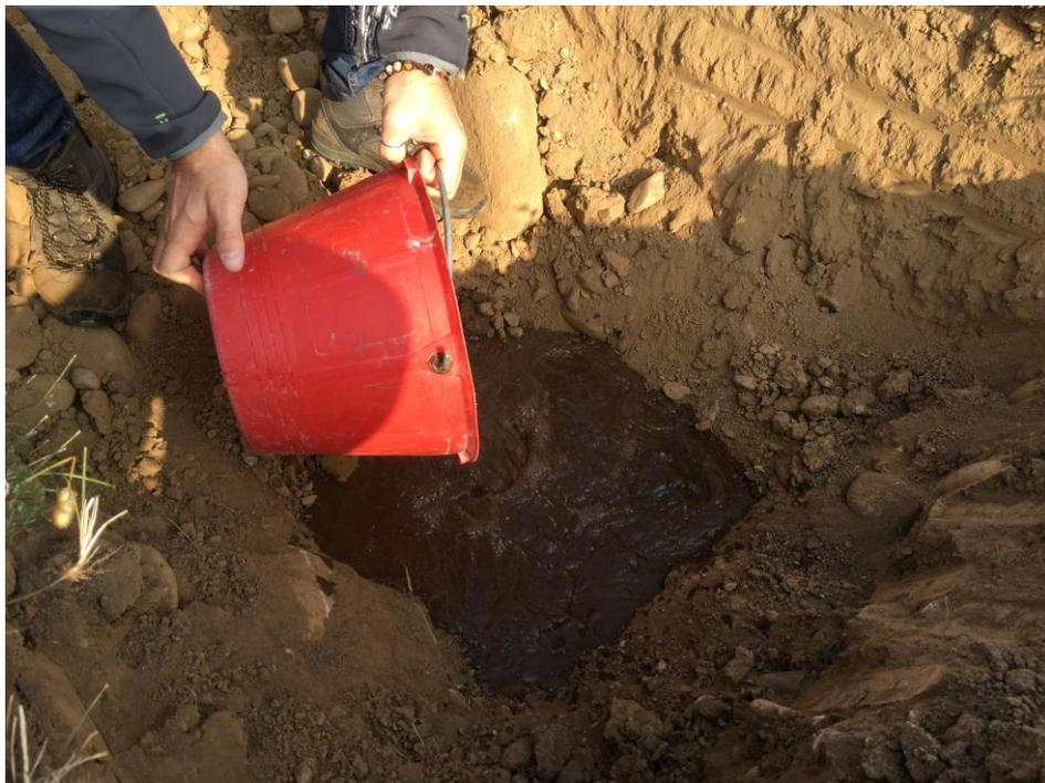
Foto 6: Fase di riempimento pozzetto P3 superficiale per prova di permeabilità n. 1.
