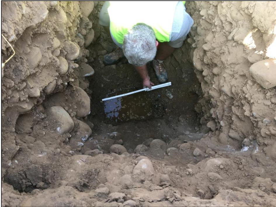
Foto 7: Fase di misura in pozzetto P3 profondo per prova di permeabilità n. 2.
