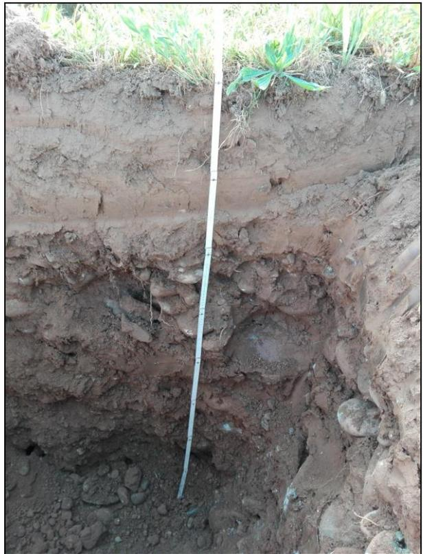
Foto 2 e 3: Pozzetto P2 nelle fasi iniziali e finali di scavo.
